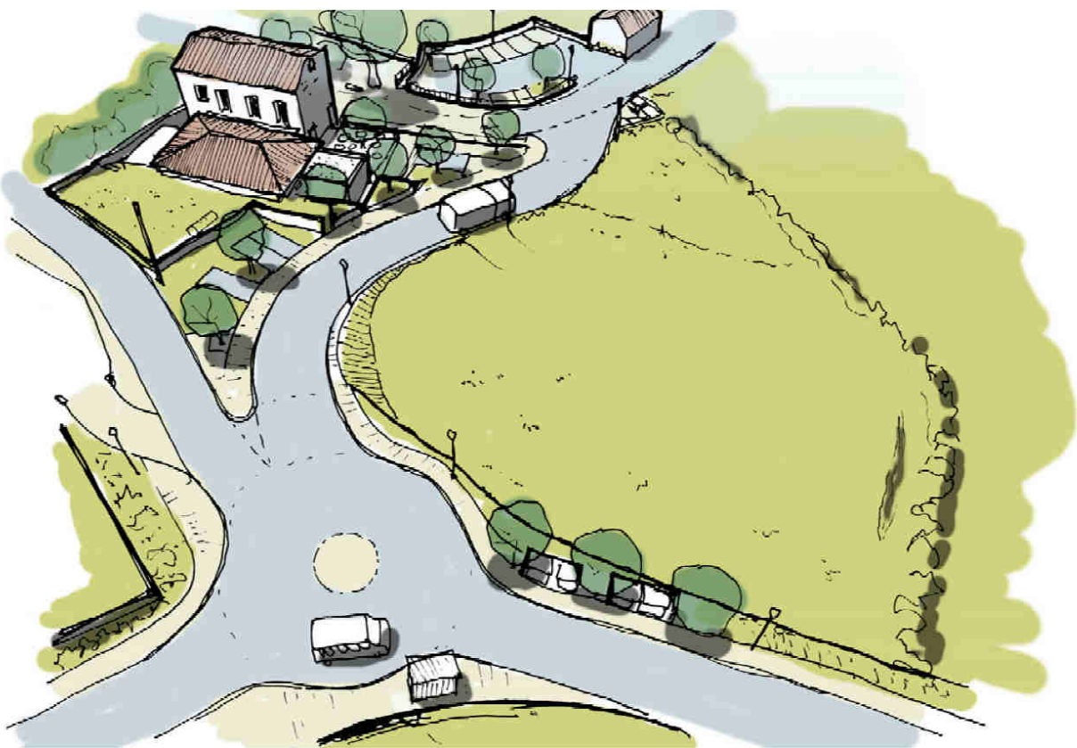
Figure 2 : Croquis des aménagements projetés vue de l'ouest (haut) et vue de l'est (bas). Au premier plan sur la vue de l'ouest, le parking projeté sur la parcelle 112 B. En arrière-plan, la voie de délestage en liaison avec les tronçons de la traverse RD 165.
