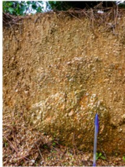
Granodiorites à biotites et amphiboles altérées : Il s'agit de l'horizon feuilleté, la texture granitique est conservée. L'altération des biotites et amphiboles confère une perte de cohésion.
