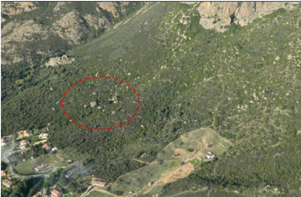
Figure 31: Vue aérienne générale des versants en contrebas du Rocher des Gozzi et identification de gros blocs observables dans la pente
