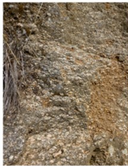
Granodiorites à biotites et amphiboles altérées : Il s'agit de l'horizon feuilleté, la texture granitique est conservée. L'altération des biotites et amphiboles confère une perte de cohésion.
