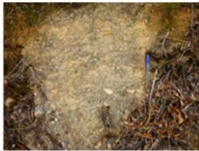
Arènes granitiques colluvionnées : Mélange non structuré d'arènes mêlées à des blocs
